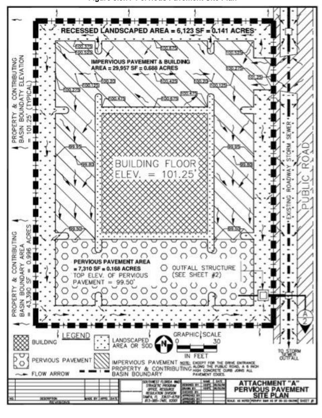
Figure 5.9.7. Pervious Pavement Site Plan
